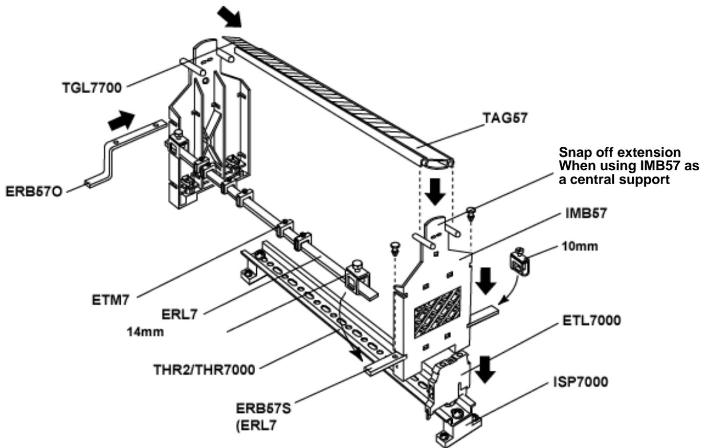
MTL7700シリーズはDINレールに簡単に取付できます。取付と同時に本安防爆接地が完了します。
